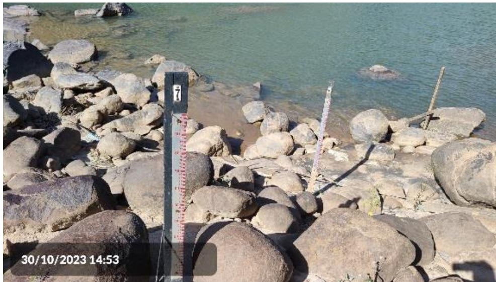
Foto 6.2-2 Manutenção preventiva e operações hidrométricas na estação UHE Mascarenhas Jusante.
