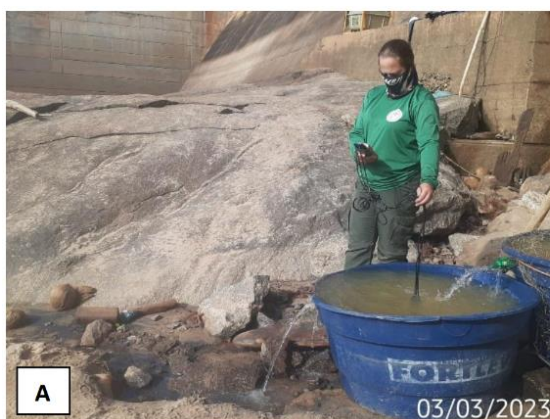
Fotos 6.4-9 e 6.4-10 Monitoramento de parâmetros abióticos da água com auxílio de sonda multiparâmetros em caixa d'água para acondicionamento e manejo dos peixes capturados.
