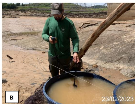
Fotos 6.4-9 e 6.4-10 Monitoramento de parâmetros abióticos da água com auxílio de sonda multiparâmetros em caixa d'água para acondicionamento e manejo dos peixes capturados.
