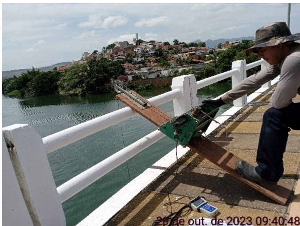
Foto 6.2-5 Manutenção preventiva e operações hidrométricas na estação UHE Mascarenhas Montante 2.
